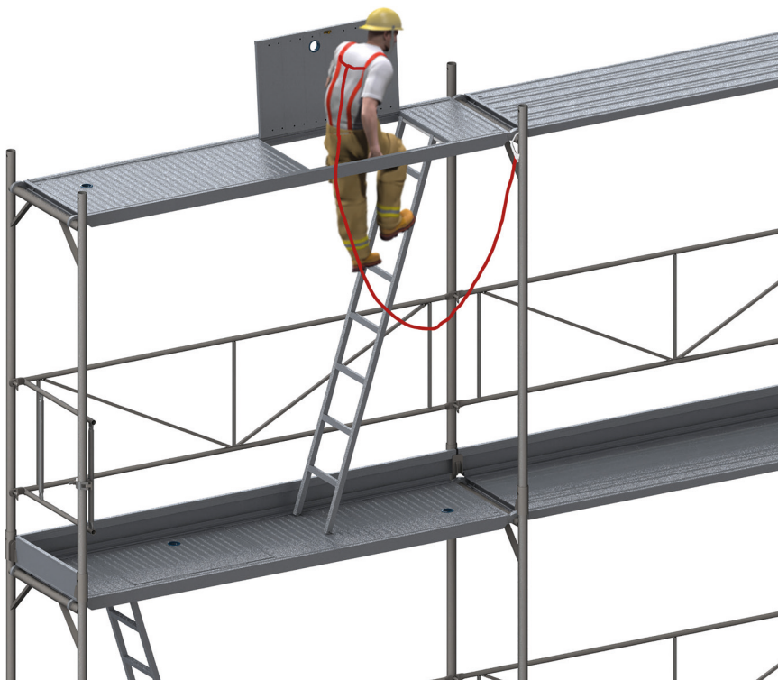
Figur 22: Säkring med PSAgA innan man tar sig upp till den högsta ställningsnivån.
