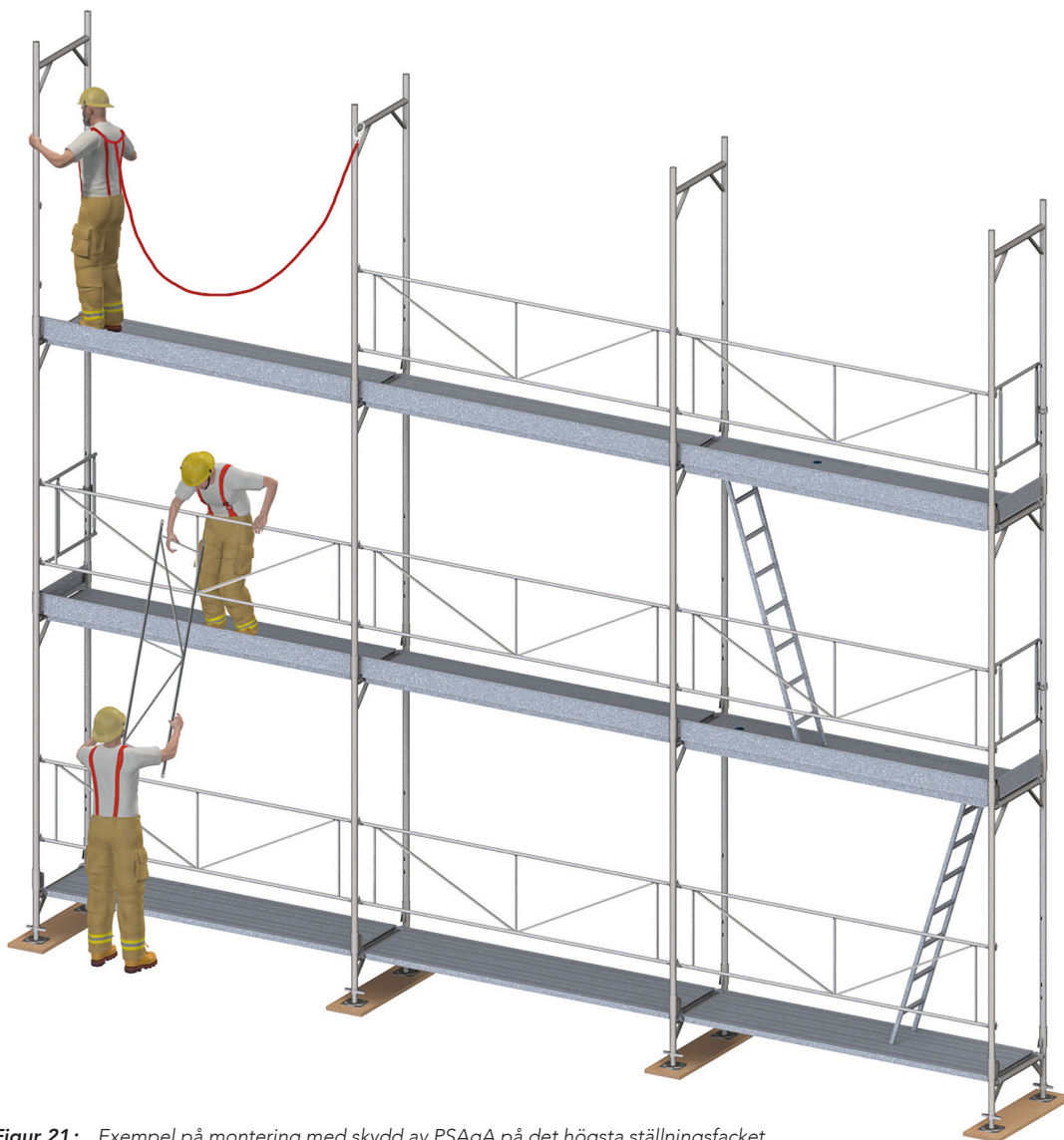
Figur 21: Exempel på montering med skydd av PSAgA på det högsta ställningsfacket.
