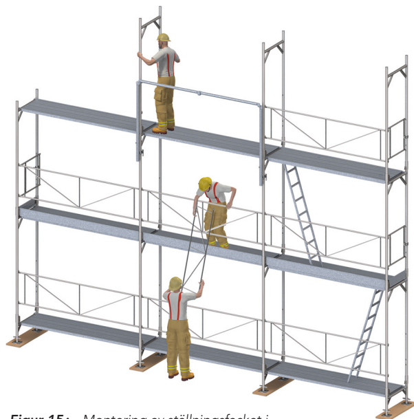
Figur 15: Montering av ställningsfacket i åtkomstfacket med skydd av MSG.
